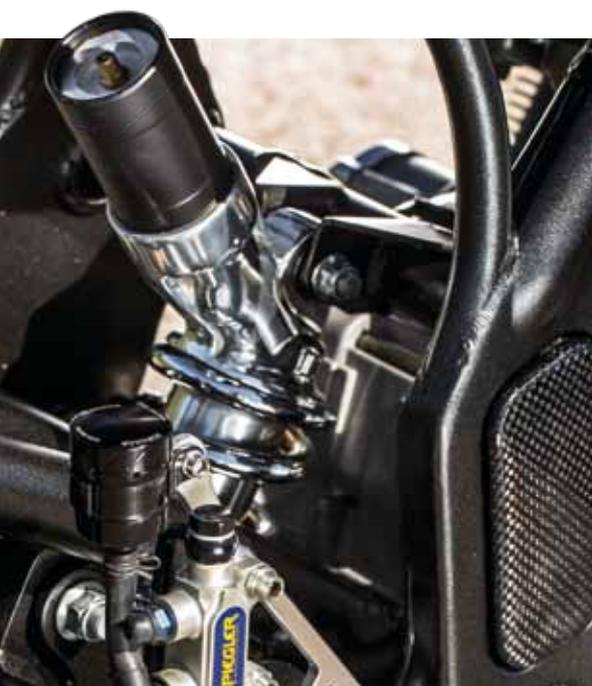
Über das polierte Federbein der Honda SC57 stützt sich die feine Krüger-Schwinge ab und schafft mit der Spiegler-Rastenanlage ein technokratisches Rennsportambiente
