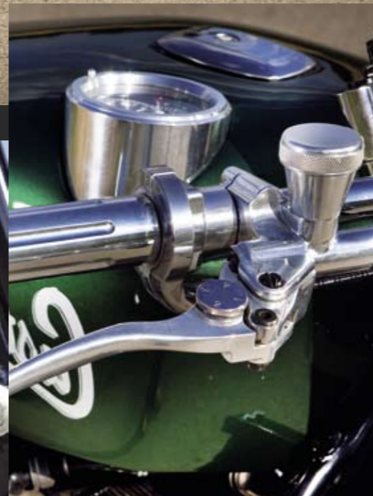
Ein kleines Detail, in dem viel Arbeit steckt: Wo der Tacho normalerweise neben der Gabel sitzt, versinkt er hier im Tank.
